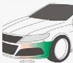
Nanášanie krycieho/ bezfarebného laku Top/Clearcoating
